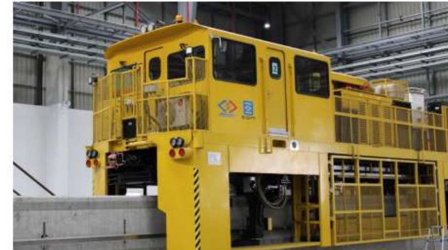
Vehículo de mantenimiento e inspección para remolcar trenes necesitando la reparación.
